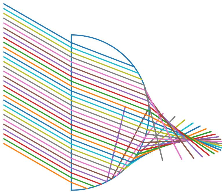
Il faut que les rayons soient proche du centre de la lentille pour respecter les conditions de Gauss. Sinon, il n'y a pas un foyer image où les rayons parallèles convergent.
