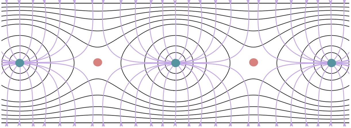
FIGURE B – Lignes de champ de  $\vec{E}(M)$  pour l'électrofiltre sec
